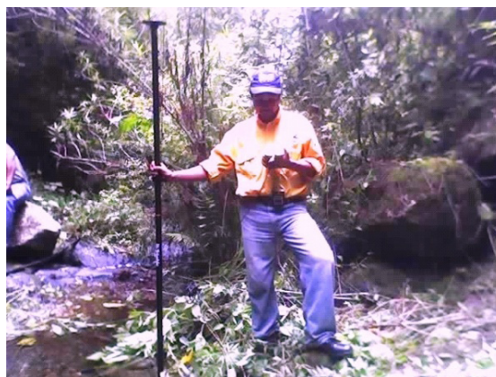
Levantamientos con GPS submétrico utilizado por Catastro Nacional en demarcación de sitios y límites jurisdiccionales.
