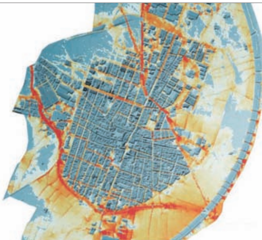
Figura 6. Resultados de la modelización con GUAD 2D: velocidades. Fuente: Análisis estratégico sobre inundaciones en el entorno de Alginet (Valencia) . Confederación Hidrográfica del Júcar. INCLAM S.A.
