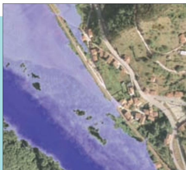
Figura 218. Mapa de calados obtenido de la simulación con geometría detallada.
