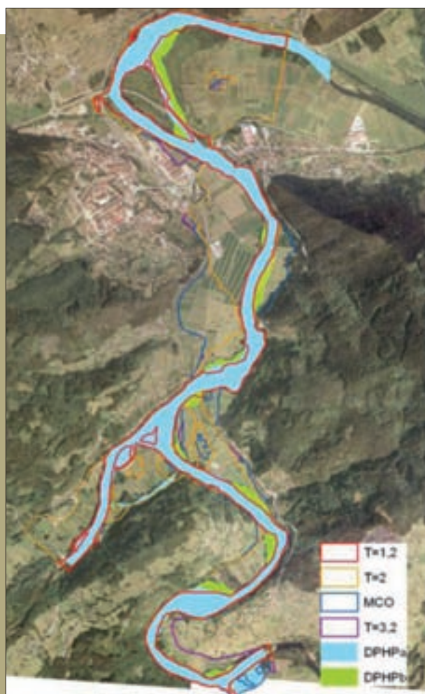
Figura 259. Zonas inundadas por un rango de caudales que se ajustan al DPHPa y DPHPb definidos en el análisis histórico y geomorfológico en el tramo bajo del río Nalón.
