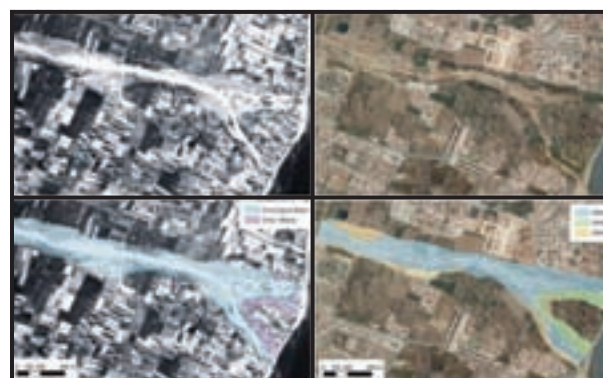
Figura 175. Representación de las opciones de DPHP en el tramo bajo del río Palancia (Valencia), a partir de los límites del cauce histórico y de las características actuales de los terrenos.
