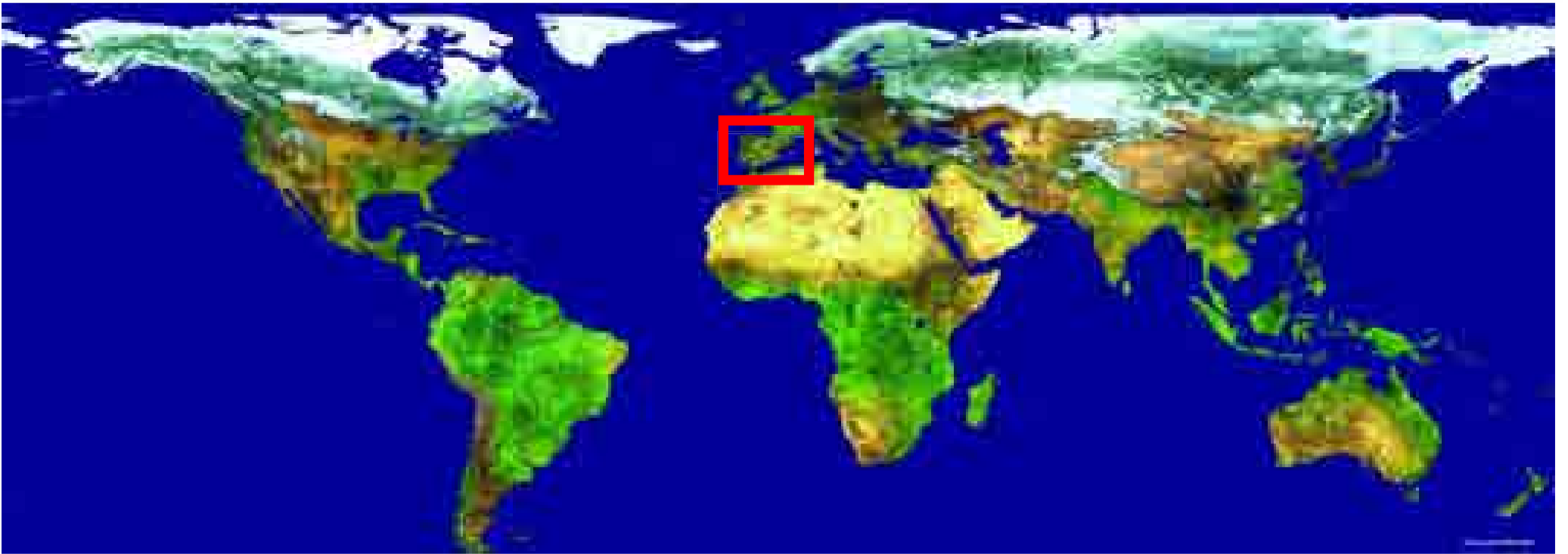
Figura 19: Mosaico de imágenes captadas, entre el 21 y el 31 de marzo de 1999, por el sensor VEGETATION, a bordo del satélite francés SPOT. Se selecciona el valor máximo de NDVI del periodo analizado.
