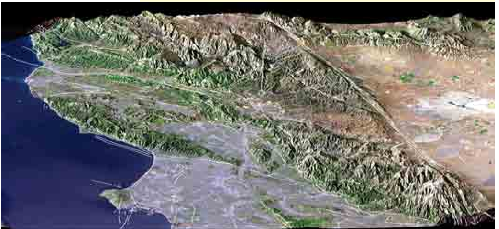
Figura 123 (abajo): Imagen tridimensional en la que se han fusionado una escena Landsat, adquirida el 4 de mayo de 2001, y un modelo digital de elevaciones extraído de una imagen SRTM tomada desde el Space Shuttle. Se aprecia la falla de San Andrés, que recorre el estado de California, desde el noroeste, en la parte superior de la imagen, hasta el sureste, en la esquina inferior derecha. Separa dos dominios fisiográficos, el sistema montañoso de San Gabriel, al oeste, del desierto del Mojave, al este. Cortesía de SRTM Team NASA/JPL/NIMA y Landsat 7 Science Team NASA GSFC/USGS
