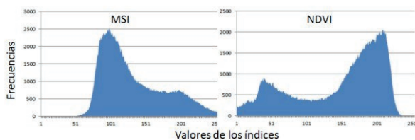
Figura 3. Representación estadística de los valores de los índices MSI y NDVI para una misma zona geográfica.
