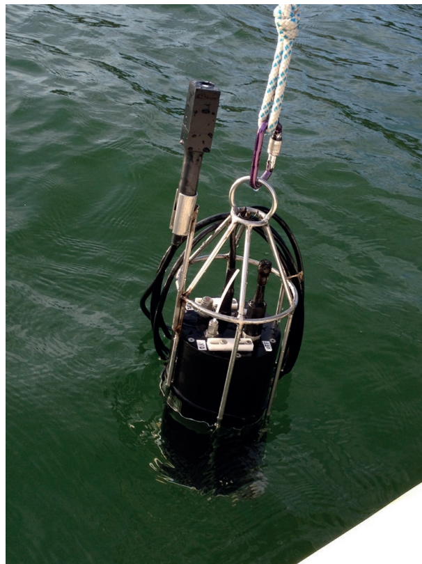
Figura 1. Espectrorradiómetro HydroRad-1 preparado para la realización del perfil vertical.
