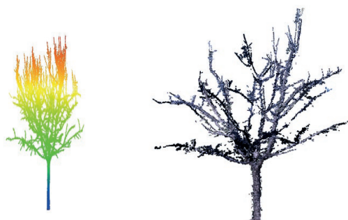
Figura 1. Nubes de puntos obtenidas de un almendro representativo del estudio mediante TLS (izqda.) y a partir de fotografías tomadas con la cámara (dcha.).
