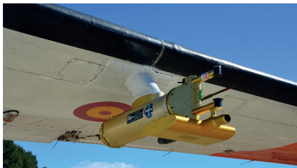
Figura 3. Sonda PCAPS montada bajo el semi-plano izquierdo del C212 n/s 301.
