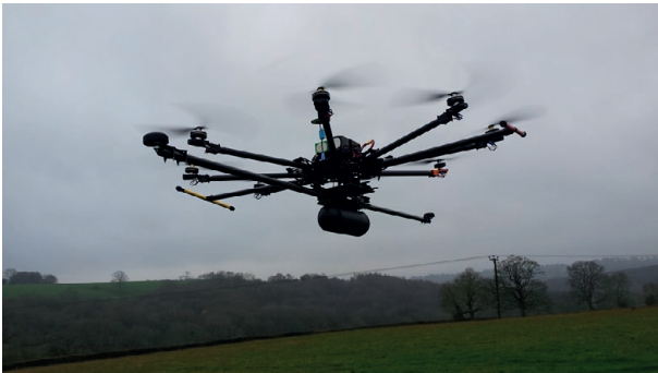
Figura 2. Sistema LIDAR “TerraSystem-LidarPod” aerotransportado en un Octocóptero
