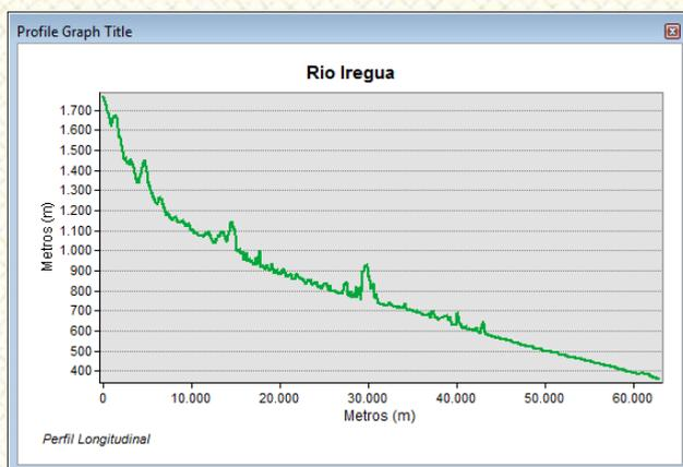
Los perfiles longitudinales pueden resultar un elemento bastante importante de ilustración temática de aspectos como los perfiles de ríos o de infraestructuras lineales como carreteras o líneas ferroviarias. Sin embargo, para obtener un perfil bien definido, debemos considerar la existencia de un modelo digital de gran resolución. De
